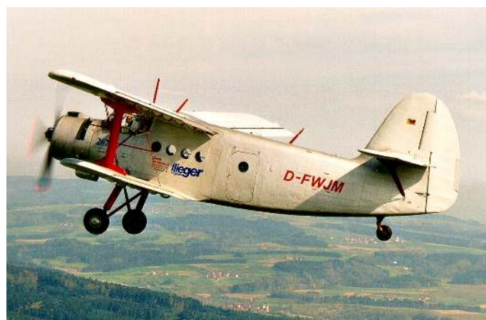
Die Antonow AN 2 „Tante Anna“ ist der größte einmotorige Doppeldecker der Welt. Mit 18 Meter Spannweite überflügelt er selbst Standard-Segelflugzeuge.
